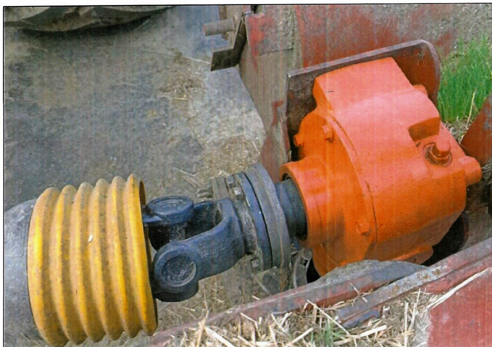
Рисунок 3 – Вид на редуктор привода режущего бруса в составе косилки КПП-9 (сверху)
