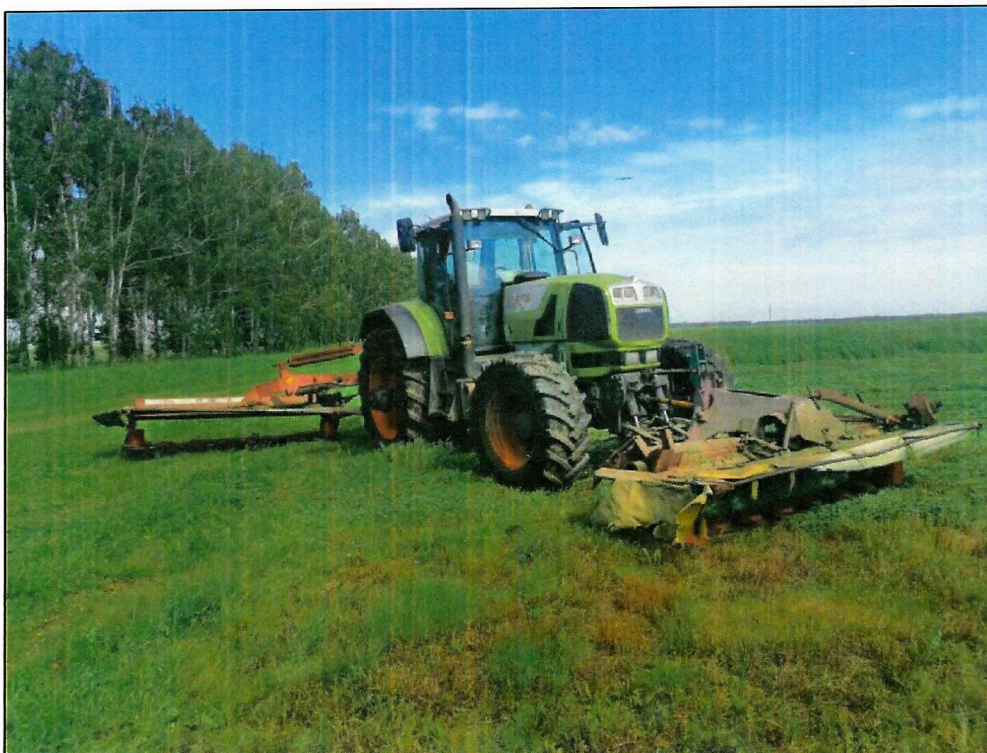
Рисунок 5 – Вид на режущие брусья и редукторы, смонтированные на косилку КПП-9 (спереди справа)
