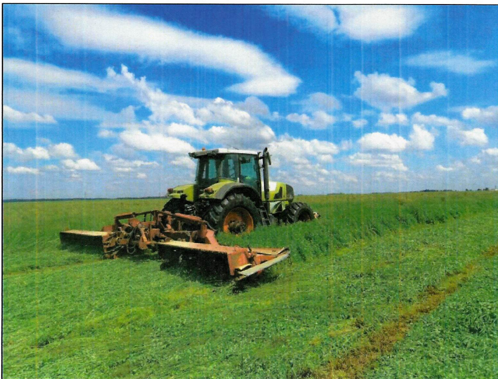
Рисунок 8 – Общий вид косилки КПр-9 с режущими брусками и редукторами в агрегате с трактором «Claas Atles 946 RZ» при выполнении технологического процесса скашивания трав
