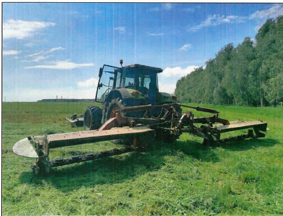
Рисунок 6 – Вид на режущие брусья и редукторы, смонтированные на косилку КПП-9 (сзади справа)
