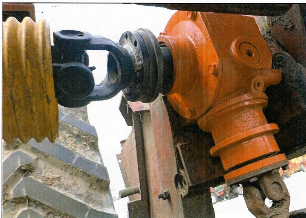
Рисунок 4 – Вид на редуктор привода режущего бруса в составе косилки КПП-9 (снизу)
