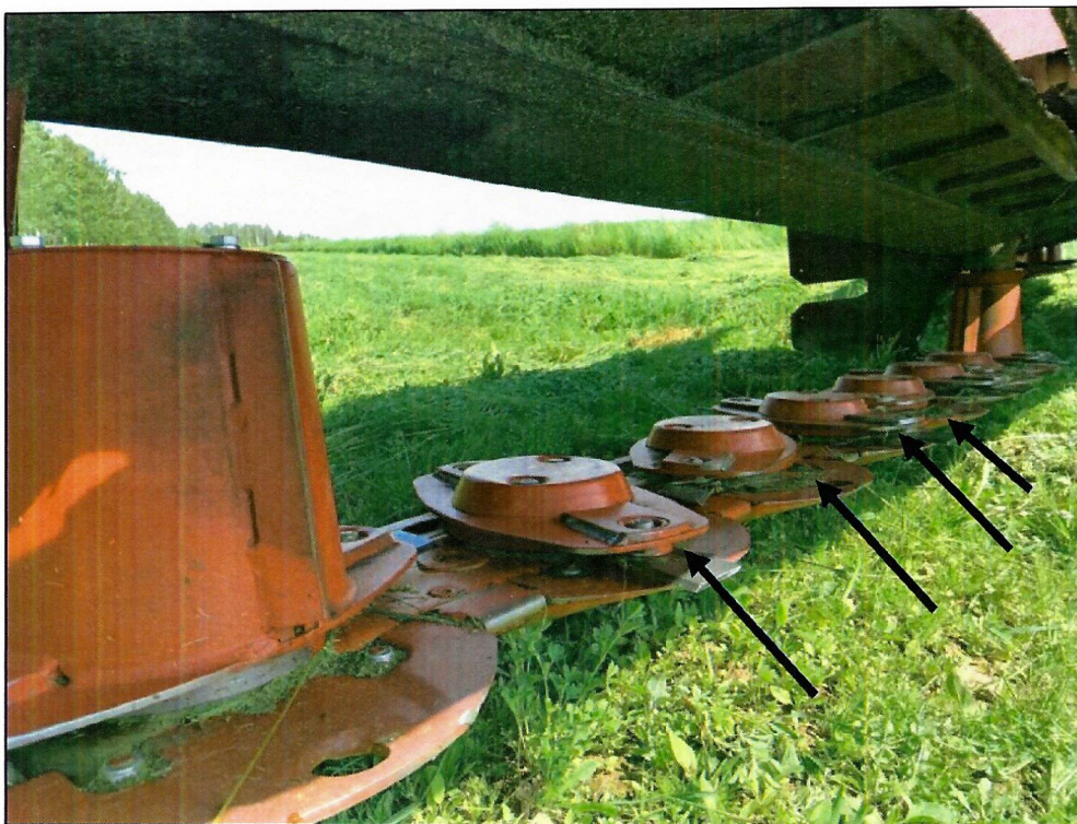
Рисунок 7 – Вид на ротор режущего бруса с ножами (указано стрелками)
