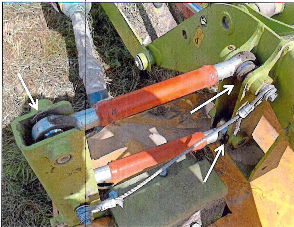
Рисунок 9 – Вид на выход из строя боковых тяг крепления бруса с рамой (место излома указано стрелками)
